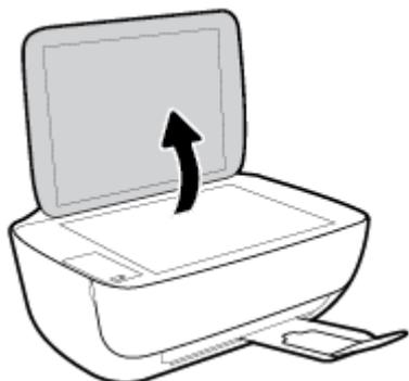
2. Cargue el documento original con la cara de impresión hacia abajo sobre la esquina derecha del cristal del escáner.
