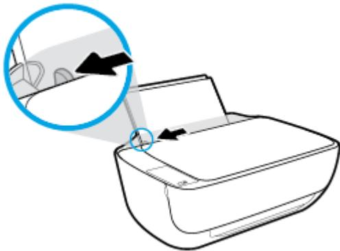
3. 將一個或多個信封插入進紙匣最右側，並將整疊信封向下推，直到不能再推入為止。
