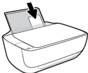
4. 將紙張寬度導板向右推，直到緊貼紙張邊緣後停止。
