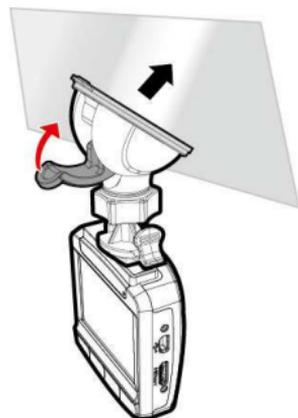
3. Tenere la base saldamente sul parabrezza e premere in giù la ganascia per montare la staffa dell'auto al parabrezza. Assicurarsi che la base sia bloccata saldamente al suo posto.
