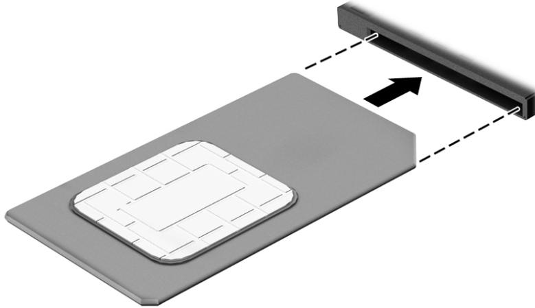
Um eine SIM-Karte zu entfernen, drücken Sie die SIM-Karte vorsichtig nach innen und ziehen Sie sie anschließend aus dem Steckplatz heraus.
