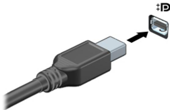
2. ケーブルのもう一方の端をデジタルディスプレイに接続します。
