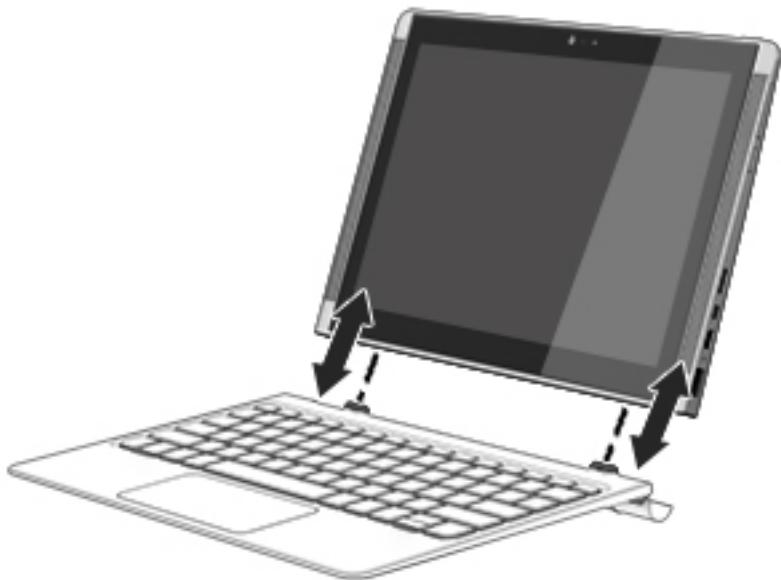
**OPREZ:** Ako tipkovnica sadrži tvrdi disk, odspojite ga prije uklanjanja tipkovnice. Ako tipkovnicu ne odspojite prije uklanjanja, tvrdi se disk i podatkovne datoteke na njemu mogu oštetiti.
