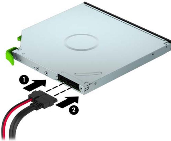
11. 如果安装新驱动器, 则将数据电缆的另一端连接至主板上的其中一个浅蓝色 SATA 接口( 标有 SATA1 和 SATA2 )。
