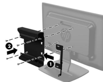
Si le montage du boîtier s'effectue sur un moniteur ProDisplay, retirez le panneau situé à l'arrière de ce dernier. Placez l'entretoise de 7 mm entre le boîtier et l'arrière du moniteur ❶, puis installez le support de sécurité de votre modèle à l'arrière du boîtier de manière à ce qu'il s'aligne avec les trous à vis du boîtier et sur le cadenas de votre modèle ❷. Fixez ensuite le boîtier et l'entretoise à l'arrière d'un moniteur à l'aide des vis à métaux de 20 mm fournies ❸.
