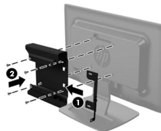
HP ProDisplayモニターにジャケットを取り付ける場合は、モニターの背面からパネルを取り外します。付属の7 mmのスペーサーをジャケットとモニター背面の間に置いてから①、お使いのモデル用のセキュリティ ブラケットをジャケットの後部に取り付けます。ブラケットとジャケットのネジ穴の位置を合わせ、南京錠を取り付けるための穴が適切な位置にします②。付属の20 mmの固定用ネジを使用して、ジャケットおよびスペーサーをモニター背面に取り付けます③。
