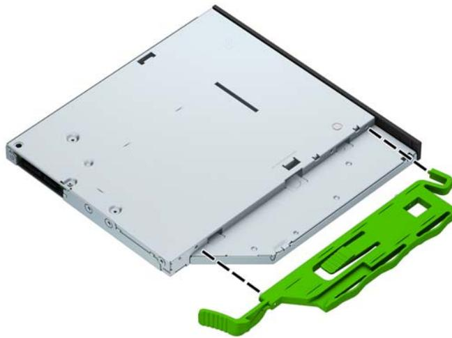
9. Far scorrere l'unità ottica attraverso la parte anteriore del telaio (1) fino a sistemarla nell'alloggiamento, in modo che la levetta verde si blocchi in posizione sul telaio (2).
