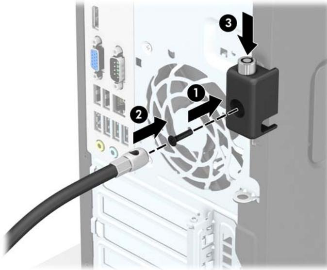
9. Tutti i dispositivi della workstation saranno stati fissati una volta completati tutti i passaggi.
