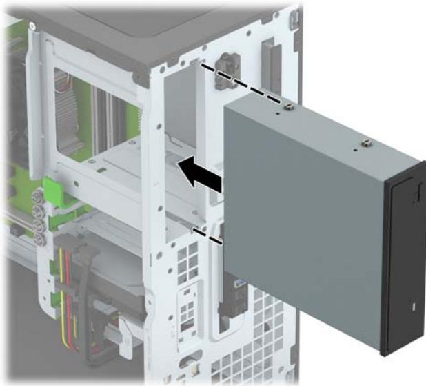
9. Collegare il cavo di alimentazione (1) e il cavo dati (2) al retro dell'unità ottica.
