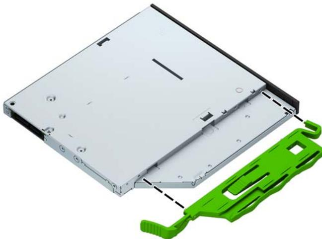
8. Far scorrere l'unità ottica attraverso il frontalino fino a sistemarla nell'alloggiamento (1), di modo che la levetta sul retro dell'unità si blocchi in posizione (2).
