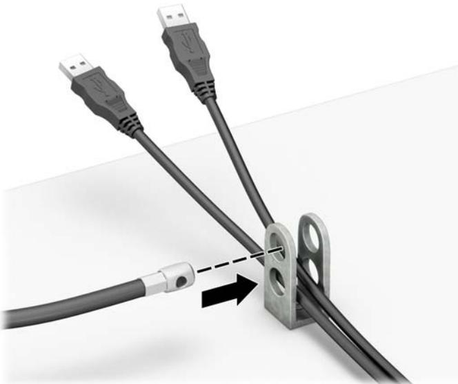
8. Avvitare il blocco al chassis mediante la vite fornita (1). Inserire l'estremità della presa del cavo di sicurezza nel dispositivo di blocco (2) e premere il pulsante (3) per attivarlo. Per disattivarlo, utilizzare la chiave fornita.
