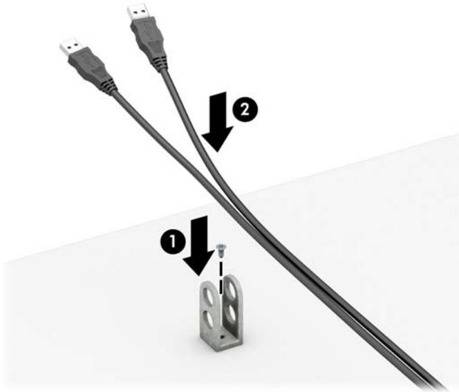
7. Far scorrere il cavo di sicurezza attraverso i fori nel dispositivo di fissaggio del cavo accessorio.
