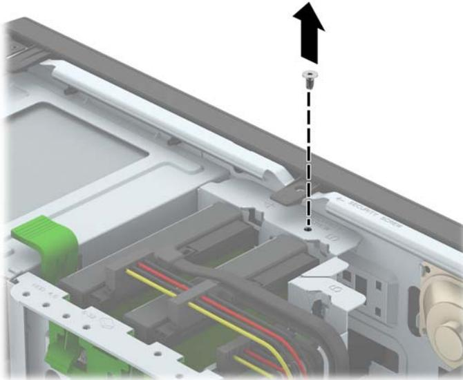
7. Installare la vite di sicurezza accanto alla linguetta di rilascio centrale del frontalino per fissare in posizione il frontalino.
