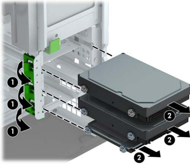
8. Rimuovere le quattro viti di montaggio (due su ciascun lato) dalla vecchia unità. Queste viti saranno necessarie per installare una nuova unità.
