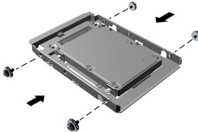
7. Far scorrere l'unità nell'apposito alloggiamento, assicurandosi di allineare le viti di montaggio con gli slot di montaggio fino a farla scattare in posizione.
