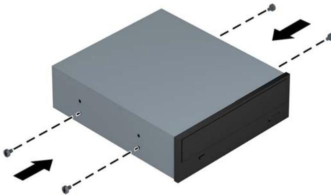
8. Far scorrere l'unità nell'apposito alloggiamento, assicurandosi di allineare le viti di montaggio con gli slot di montaggio fino a farla scattare in posizione.
