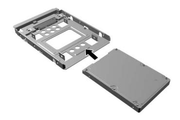
4 つの黒色のアダプター ブラケット用 M3 ネジをベイ アダプター ブラケットの側面か らドライブに取り付けて、ドライブをブラケットに固定します。
