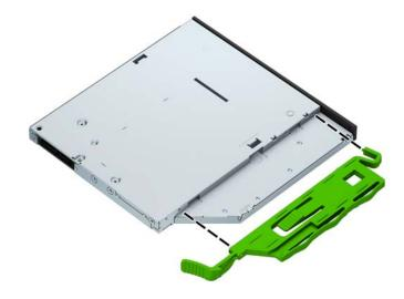
8. オプティカル ドライブをフロント パネルを通してベイの奥までスライドさせ(1)、ドライブの 背面にあるラッチを所定の位置に固定します(2)。
