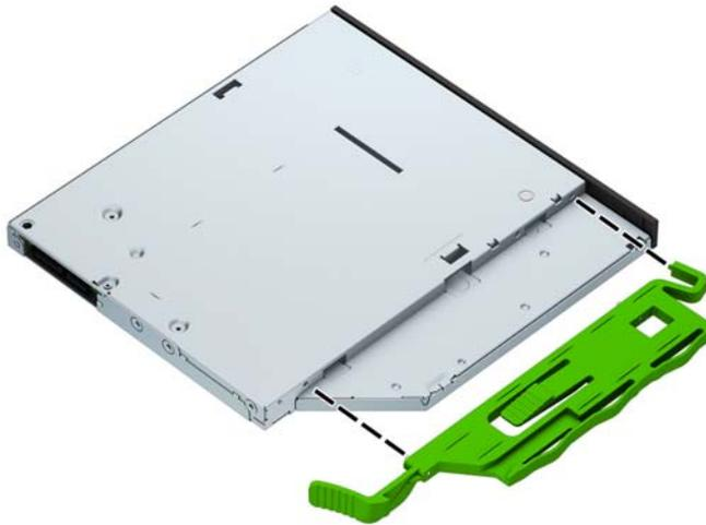
8. Deslice la unidad óptica hasta introducirla en el compartimiento a través del panel frontal (1), de forma que el pestillo de la parte trasera de los bloqueos de la unidad queden en su lugar (2).
