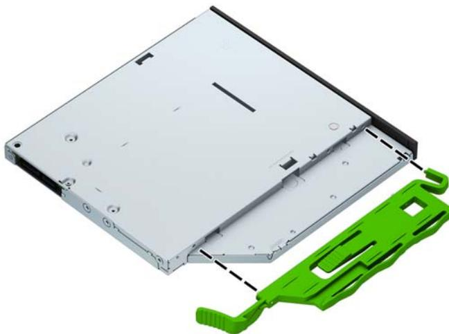
9. オプティカルドライブをシャーシの前面を通してベイの所定の位置に収まるまでスライドさせ (1)、電源ケーブル (2) およびデータケーブル (3) をドライブの背面に接続します。
