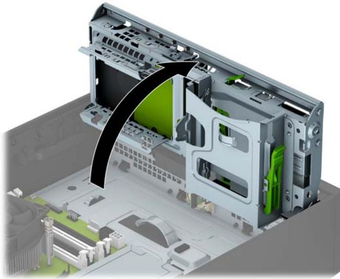
9. Alinee los tornillos de montaje de la unidad con las ranuras J de los laterales del compartimiento de la unidad. Levante la unidad para introducirla en el compartimiento y, a continuación, deslícela hacia delante hasta que encaje en su sitio.
