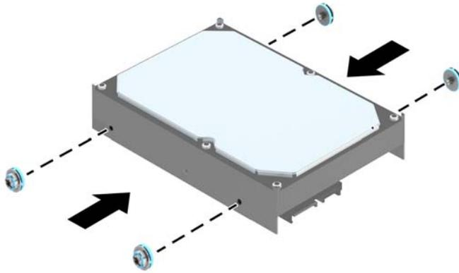
10. Alinee los tornillos de montaje con las ranuras en el chasis del compartimiento para unidades, presione la unidad de disco duro en el compartimiento y luego deslícela hacia adelante hasta que se detenga y encaje en su posición.
