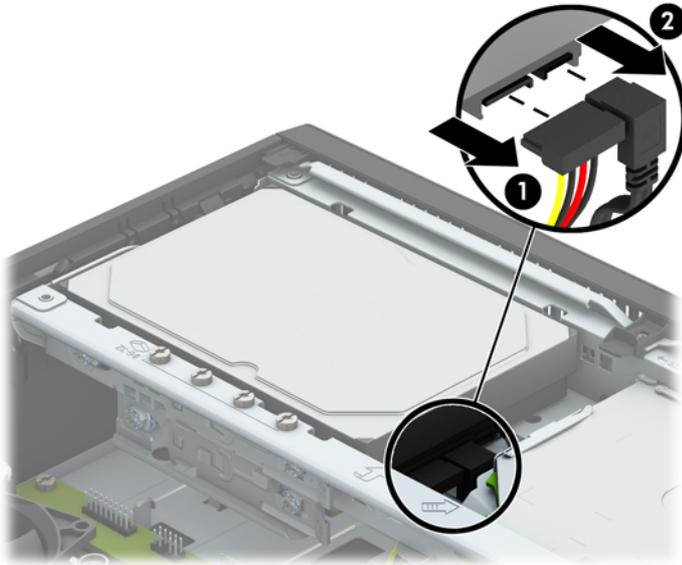
8. Tire hacia fuera de la palanca de liberación situada junto a la parte trasera de la unidad de disco duro (1). Mientras tira de la palanca de liberación hacia fuera, deslice la unidad hacia atrás hasta que se detenga y luego levántela y extráigala del compartimiento (2).
