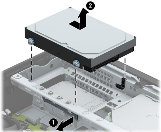
9. Para instalar una unidad de disco duro, debe transferir los tornillos de montaje de la unidad antigua a la nueva.
