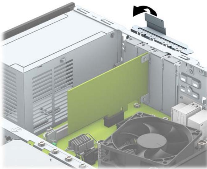
14. Conecte los cables externos en la tarjeta instalada, si es necesario. Conecte los cables internos en la placa del sistema, si es necesario.
