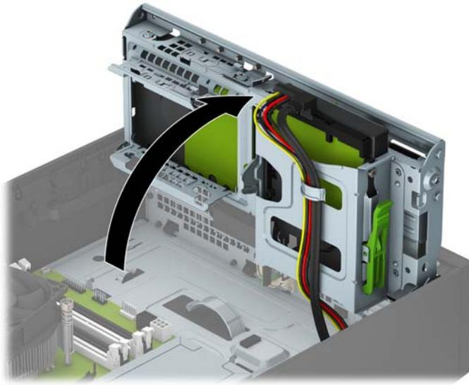
8. Desconecte el cable de alimentación (1) y el cable de datos (2) de la parte trasera de la unidad de disco duro. Presione el pestillo de liberación del lateral del gabinete de la unidad (3) y luego deslice la unidad fuera del compartimiento de la unidad (4).
