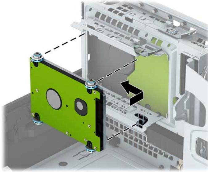
10. Conecte el cable de alimentación (1) y el cable de datos (2) en la parte trasera de la unidad de disco duro.
