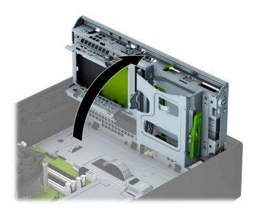
9. 將磁碟上的固定螺絲對準磁碟機插槽側面的」型溝槽。將磁碟向上推入磁碟機插槽中,然後向前滑 動直到鎖至定位。
