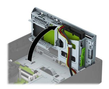
拔除硬碟背面的電源線(1)和資料排線(2)。壓下磁碟機箱側面的釋放門(3),然後將磁碟從磁碟機 插槽滑出(4)。
