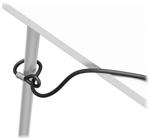
**3.** Provucite bezbednosni kabl kroz pričvršćivač za bezbednosni kabl.
