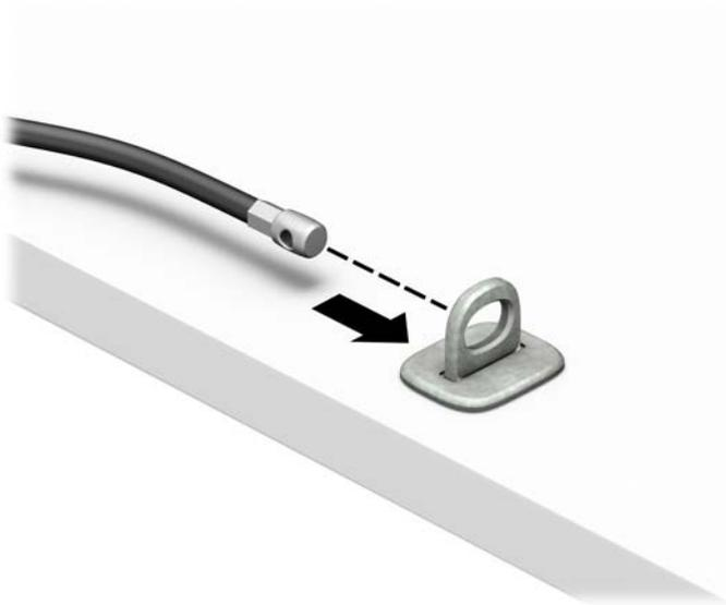
4. Puxe as duas hastes da tesoura metálica da trava do monitor e insira a trava no slot de segurança na parte traseira do monitor (1). Feche a tesoura para prender a trava no lugar (2) e, em seguida, deslize o guia do cabo através do centro da trava do monitor (3).
