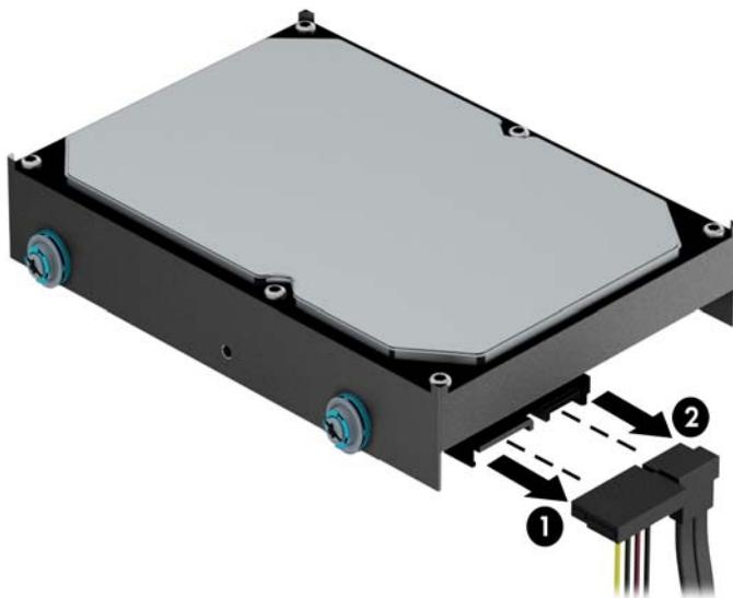
7. 将驱动器旁的绿色锁定器向外拉 (1), 然后将驱动器从托架中滑出 (2)。
