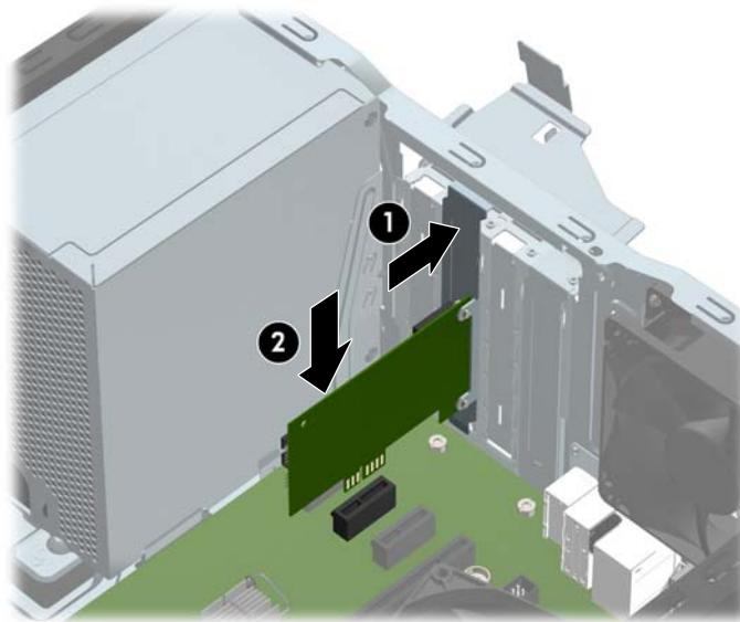
**注：**安装扩展卡时，请用力按压扩展卡，使整个连接器正确插入扩展卡插槽。
