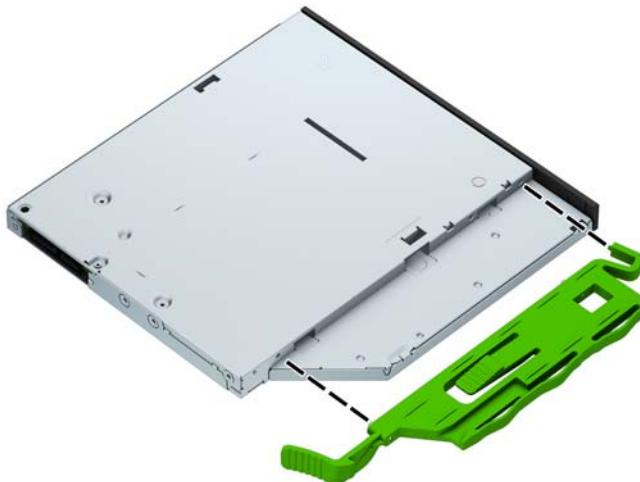
9. 将光驱从机箱正面径直推入托架 (1)，直到绿色锁定器锁定到机箱框架 (2)。
