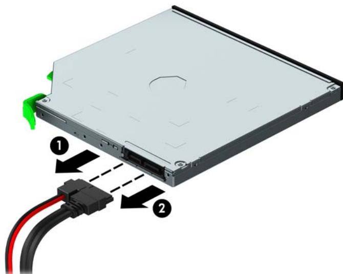
**⚠ 注意：**拔下电缆时，请拉动卡舌或连接器而非电缆本身，以避免损坏电缆。
