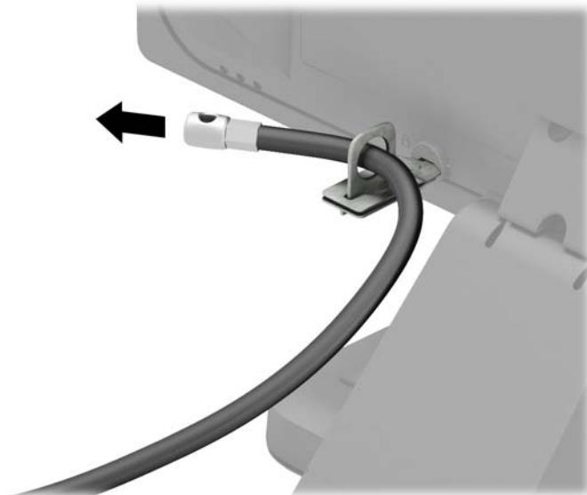
6. 根据您的环境使用合适的螺钉，将配件缆锁扣件安装到桌面上（未提供螺钉）(1)，然后将配件缆线放入扣件基座中(2)。
