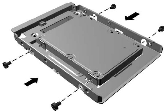
7. 将四颗安装螺钉安装到 3.5 英寸驱动器或 2.5 英寸驱动器适配器支架的侧面（每侧各安装两颗）。
