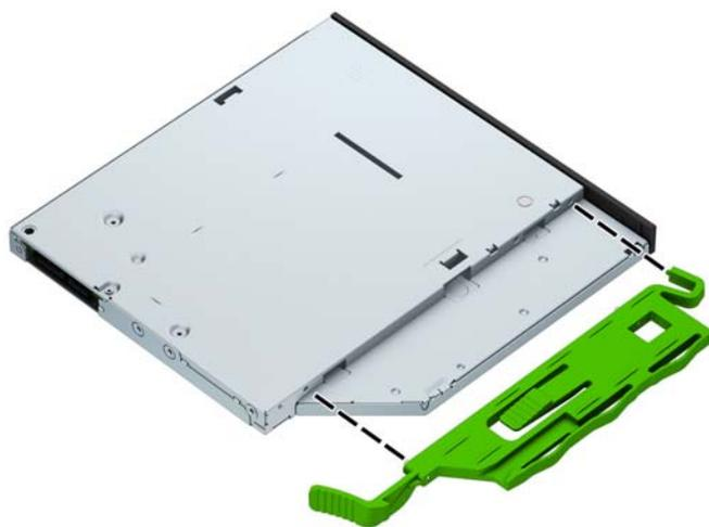
9. Povucite optički pogon kroz prednju stranu kućišta (1) do kraja u ležište, tako da zeleni zasun prihvatí okvir kućišta (2).
