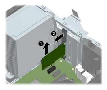
c. Si va a extraer una tarjeta PCI Express x16, aleje de la tajeta el brazo de retención ubicado en la parte trasera del socket de expansión y cuidadosamente mueva la tarjeta hacia adelante y hacia atrás hasta que los conectores sean liberados del socket. Levante la tarjeta de expansión directamente hacia arriba y luego extráigala del interior del chasis para retirarla. Asegúrese de no rozar la tarjeta contra otros componentes.
