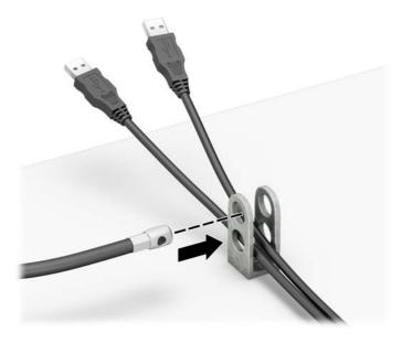
8. Atornille el bloqueo al chasis utilizando el tornillo suministrado (1). Inserte el extremo del cable de seguridad en el bloqueo (2) y presione el botón (3) para activar el bloqueo. Utilice la llave suministrada para desactivar el bloqueo.
