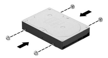
8. Deslice la unidad dentro del compartimiento, asegurándose de alinear los tornillos de montaje con las ranuras guía, hasta que la unidad encaje en su lugar.
