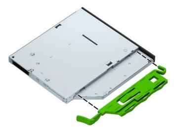
9. Deslice la unidad óptica hasta introducirla en el compartimiento a través de la parte frontal del chasis (1), de forma que el pestillo verde quede encajado en el bastidor del chasis (2).
