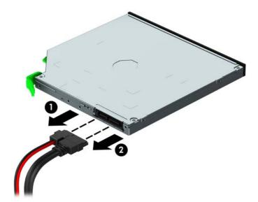
PRECAUCIÓN: Para evitar dañar el cable al retirarlo, tire de la lengüeta o del conector, pero no del cable en sí mismo.
