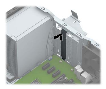
**b.** Si va a extraer una tarjeta PCI Express x1, sosténgala por cada extremo y, con cuidado, mueva la tarjeta hacia delante y hacia atrás hasta que los conectores se suelten del zócalo. Levante la tarjeta de expansión directamente hacia arriba (1) y luego extráigala del interior del chasis (2) para retirarla. Asegúrese de no rozar la tarjeta contra otros componentes.
