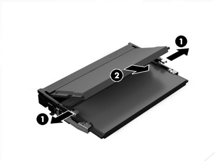
15. Para instalar um módulo da memória, faça deslizar o SODIMM para a ranhura com um ângulo de aproximadamente 30° (1) e em seguida pressione o SODIMM (2) para encaixar as patilhas no lugar.
