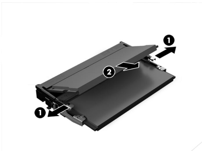
15. 若要安裝記憶體模組，請將新的 SODIMM 以大約 30° 角滑入插槽 (1)，然後將 SODIMM 往下壓 (2)，如此卡榫才能將它鎖入定位。
