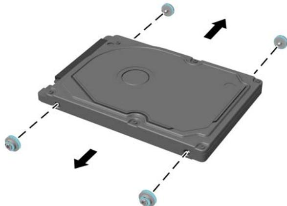
Untuk petunjuk pemasangan HDD, lihat [Memasang drive hard disk 2,5 inci pada hal. 51](#).
