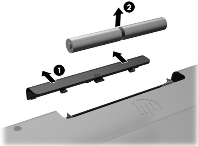
Untuk melepas baterai dari mouse nirkabel, lepas pintu baterai di bagian bawah mouse (1) lalu keluarkan baterai dari ruang baterai (2).
