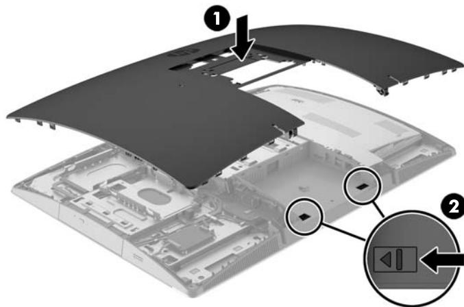
21. Jika model komputer Anda ProOne 400, gunakan obeng pipih atau obeng Torx memutar sekrup panel akses seperempat putaran ke kanan untuk mengunci panel akses.
