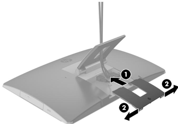
5. Anda dapat mencegah akses ke komponen internal dan port dengan mengamankan penutup port belakang. Gunakan obeng Torx T15 tahan rusak untuk memasang sekrup penahan ke sasis.
