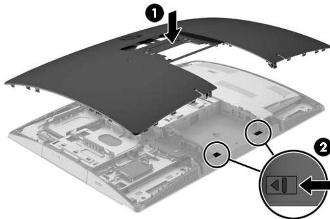
7. Jika model komputer Anda ProOne 400, gunakan obeng pipih atau obeng Torx memutar sekrup panel akses seperempat putaran ke kanan untuk mengunci panel akses.
