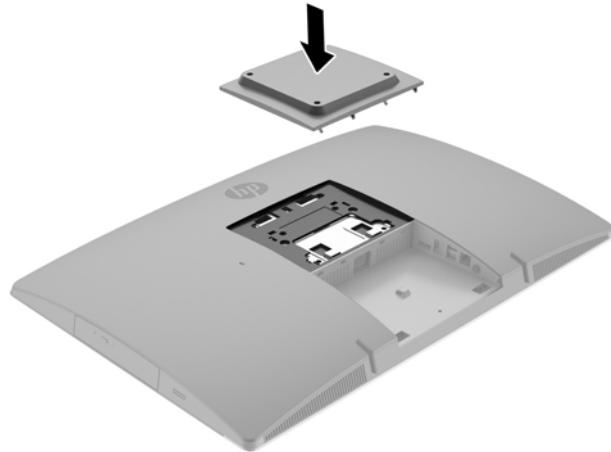
2. Untuk memasang komputer pada lengan ayun (dijual terpisah), masukkan empat sekrup 20 mm yang tersedia melalui lubang yang terdapat pada pelat lengan ayun dan ke dalam lubang pemasangan pada komputer.
