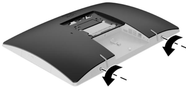
10. Deslice los pestillos del panel de acceso el uno hacia el otro (1).
