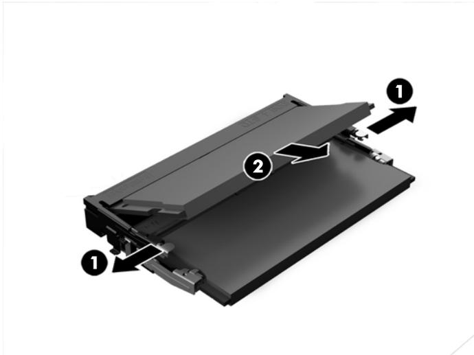
15. Para instalar un módulo de memoria, deslice el nuevo SODIMM en el hueco en un ángulo de aproximadamente 30° grados (1) luego presione el SODIMM hacia abajo (2) para que encaje en su lugar.
