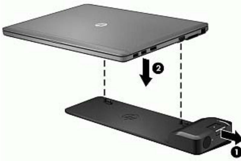
3. Tekan tombol penghubung **(1)** pada perangkat penghubung ke arah dalam untuk mengencangkan perangkat penghubung pada komputer. Lampu penghubung **(2)** menyala bila komputer terpasang dengan baik pada perangkat penghubung.
