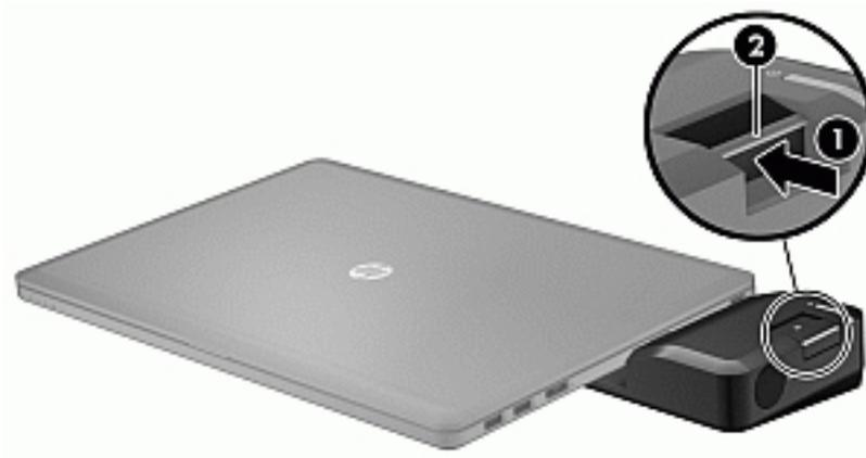
Untuk menghubungkan perangkat port ekspansi ke komputer
