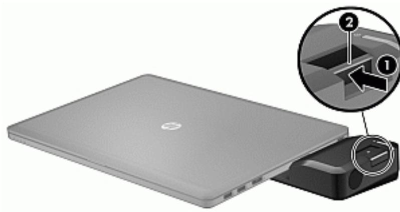
Para conectar el dispositivo de puerto de expansión al equipo.
