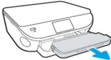
2. En la parte inferior de la bandeja de salida, mueva el bloqueo de la bandeja de salida a la posición de desbloqueo y luego eleve y la palanca de desbloqueo para desbloquear la extensión de la bandeja.
