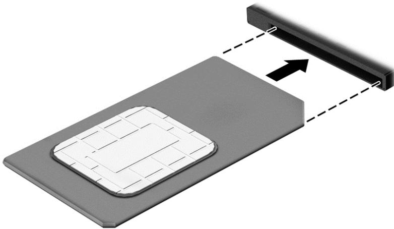
SIM カードを取り出すには、SIM カードをいったんスロットに押し込んで、固定を解除してから引き抜きます。
