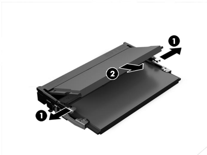
13. Deslize o novo SODIMM (1) para dentro do soquete num ângulo de aproximadamente 30°, depois pressione o SODIMM para baixo (2) de forma que as travas se encaixem corretamente.
