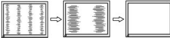
3. Sollte nach dem Anpassen des Takts die Anzeige weiterhin verschwimmen oder flimmern oder sollten weiterhin Streifen erscheinen, passen Sie die Phasenlage an.
