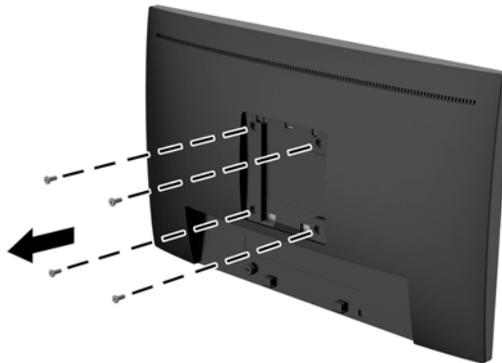
3. Befestigen Sie die Montageplatte an der Wand oder einem Schwenkarm Ihrer Wahl mithilfe der vier Schrauben, die aus den VESA-Öffnungen an der Rückseite des Displaykopfes entfernt wurden.
