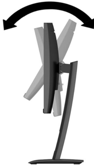
2. Drehen Sie den Displaykopf nach links oder rechts, um einen optimalen Sichtwinkel zu erhalten.
