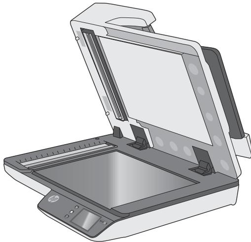
2. Use um pano limpo, que não solte fiapos, umedecido com água ou borrife o limpa-vidros no pano e, em seguida, limpe completamente o vidro do scanner de mesa.
