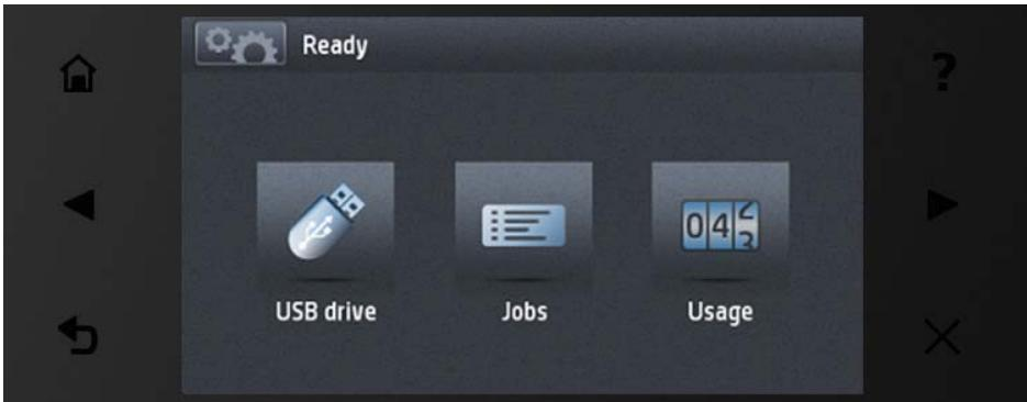
前面板有一大块中央区域，可用以显示动态信息和图标。在左右两侧，您可以在不同情况下看到最多 6 个固定图标。通常情况下，它们不会同时显示。
