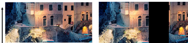
Originál Sken je ovlivněn selháním modulu CIS
