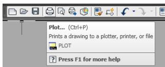
3. Das Fenster „Plot“ (Drucken) wird geöffnet. Sie können auf weitere Optionen zugreifen, indem Sie rechts unten auf die runde Schaltfläche klicken.
