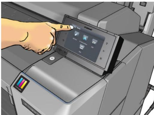
Das Bedienfeld befindet sich auf der rechten Vorderseite des Druckers. Hiermit können Sie den Drucker komplett steuern: Vom Bedienfeld aus können Sie kopieren, Informationen zum Drucker abrufen, die Druckereinstellungen ändern, Kalibrierung und Tests durchführen usw. Auf dem Bedienfeld werden gegebenenfalls auch Meldungen angezeigt (Warn- und Fehlermeldungen). Informationen zur Verwendung des Bedienfelds sind im gesamten Handbuch zu finden.
