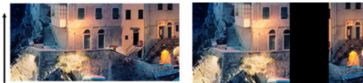
Original Numérisation affectée par un module CIS défectueux
