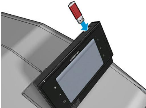
4. A impressora leva cerca de 1 minuto para ler o arquivo de firmware, e solicita a remoção da unidade flash USB.
