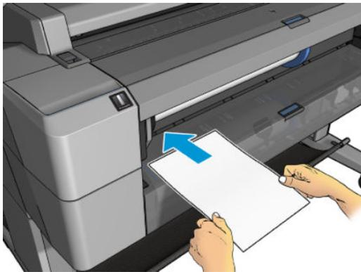
6. Alinhe a borda esquerda da folha com a linha azul no lado esquerdo da impressora.
