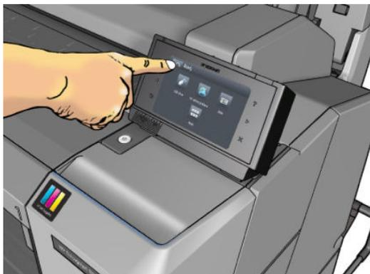
O painel frontal está localizado na parte frontal direita da impressora. Ele permite controle total da impressora: pelo painel frontal, você pode imprimir, visualizar informações sobre a impressora, alterar as configurações da impressora, executar calibrações e testes etc. O painel frontal também exibe alertas (mensagens de erro e aviso) quando necessário. Você pode encontrar informações sobre usos específicos do painel frontal em todo este guia.
