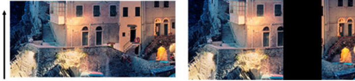
Original (Orijinal) Hatalı CIS modülünden kaynaklanan tarama
