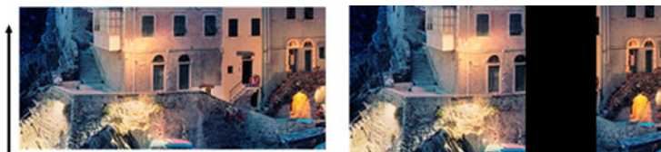
原件 CIS 有故障模块所影响的扫描
