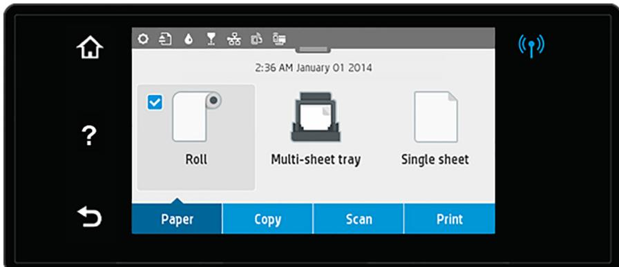
前面板有一个较大的中心区域，用于显示动态信息和图标。中心区域顶部是显示主屏幕图标的控制板。要与这些图标进行交互，请向下滑动控制板状态以访问控制板。
