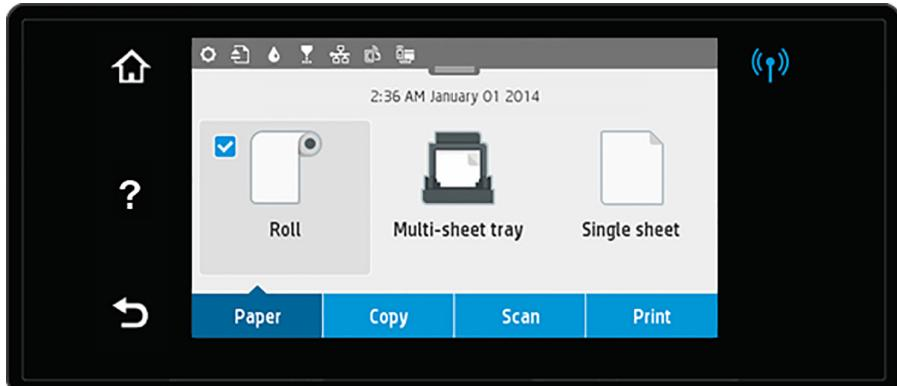
前控制面板有一個大型的中央區域，可顯示動態資訊及圖示。在中央區域的頂端有顯示面板，可顯示主畫面圖示。向下撥動顯示面板狀態以存取顯示面板，即可與這些圖示互動。
