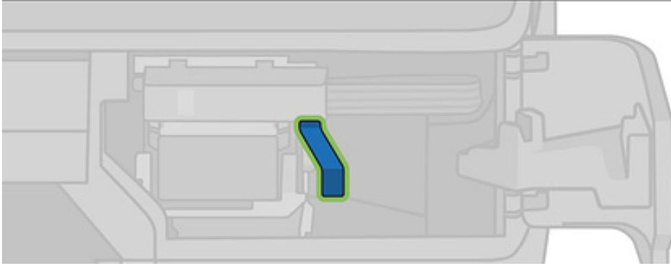
6. Heben Sie den blauen Hebel an, um den Schlauchanschluss zu lösen, und lagern Sie den Schlauchanschluss an der Schlauchanschlusshalterung in der Zugangsklappe des Druckers.
