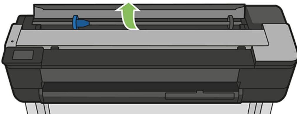
3. Setzen Sie die Spindel in den Drucker ein. Halten Sie sie dabei an beiden Enden fest. Der blaue Anschlag muss, von der Vorderseite des Druckers aus betrachtet, nach links zeigen.
