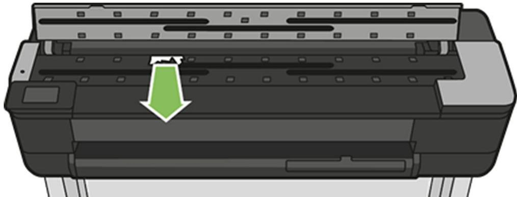
**⚠ ACHTUNG:** Verschieben Sie das Druckmaterial nicht seitwärts, da der Scanner sonst beschädigt werden könnte.
