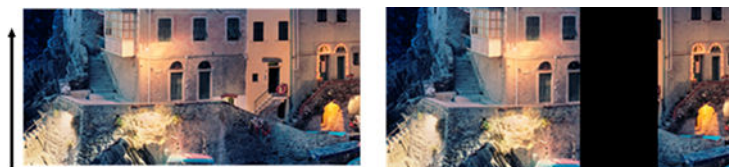
Σάρωση πρωτοτύπου με βλάβη ράβδου σάρωσης
