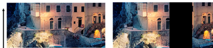
Scansione originale con una barra di scansione malfunzionante
