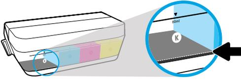
您必须在墨水量低于最低墨水标示线之前重新填充墨水。
