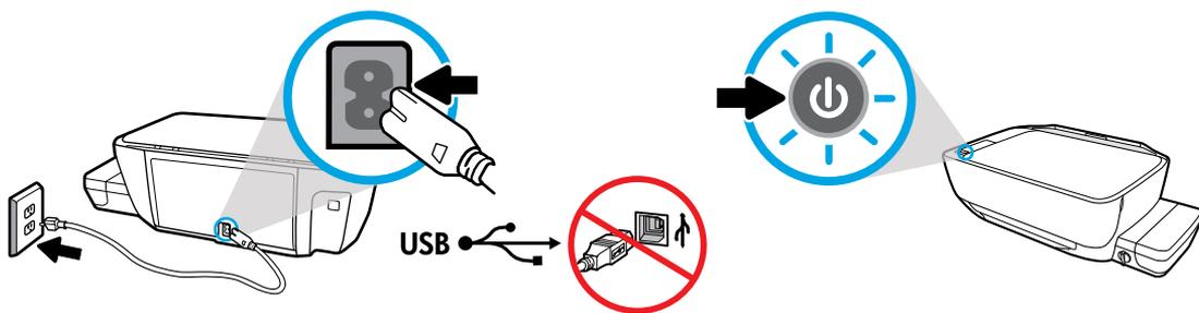
插入电源线打开电源。软件安装期间，请在弹出提示后再连接 USB 电缆。
