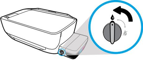
打印前，您必须解除墨水阀的锁定状态（置于垂直位置），以使墨水能够流动。
