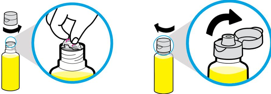
取下黄色瓶盖，去除封口。旋紧瓶盖，翻开墨罐盖。
