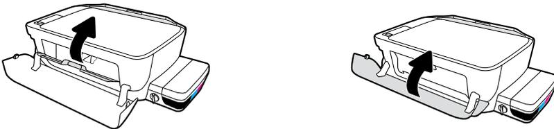
关闭打印头检修盖，然后关闭前盖。
