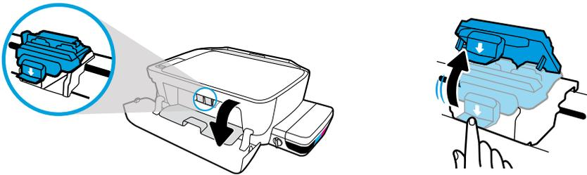
打开前盖和打印头检修盖。向下按以打开蓝色托架卡销。
