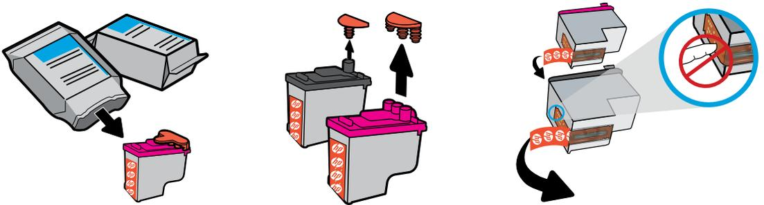
从打印头顶取出塞子，然后使用拉片将胶带从触点移除。
