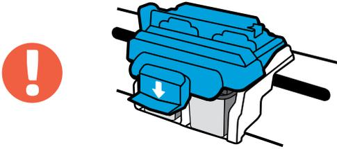
**重要提示！** 安装打印头后，请使蓝色托架卡销保持关闭状态。
