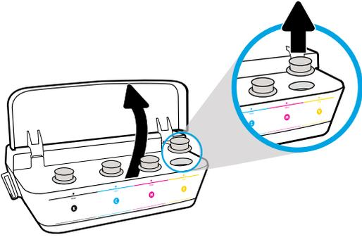
打开墨罐盖子。拔下黄色墨罐塞。
