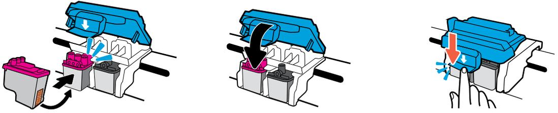
滑入打印头直到听到喀嗒声。紧紧关闭蓝色托架卡销。
