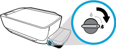
移动或倾斜打印机前，您必须锁定墨水阀（置于水平位置），以防墨水泄露。
