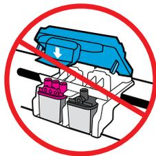
在打印头已注满墨水后，不得打开蓝色托架卡销。打开卡销可能会导致打印头永久损坏。
