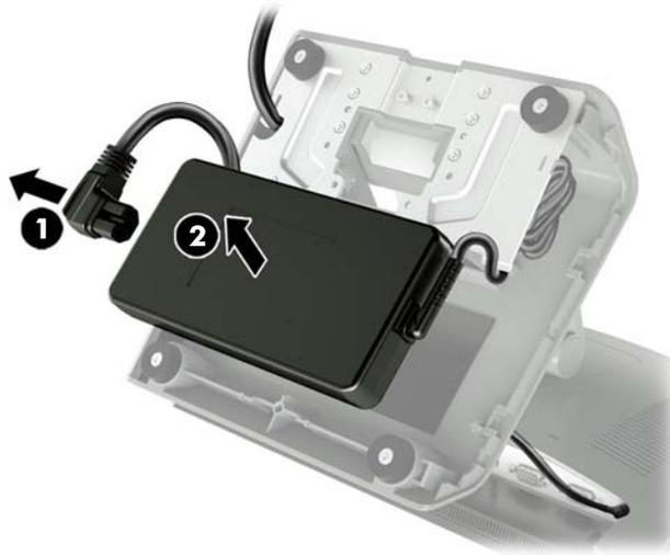
8. Provucite pričvršćenu stranu novog kabela za napajanje kroz rupu u sredini baze i priključite ga u priključak za istosmjernu struju na stražnjoj ploči (1). Postavite novi izvor napajanja u bazu postolja (2) i priključite kabel za napajanje izmjeničnom strujom na stranu izvora napajanja (3) te provucite kabel kroz utor držača na bazi.
