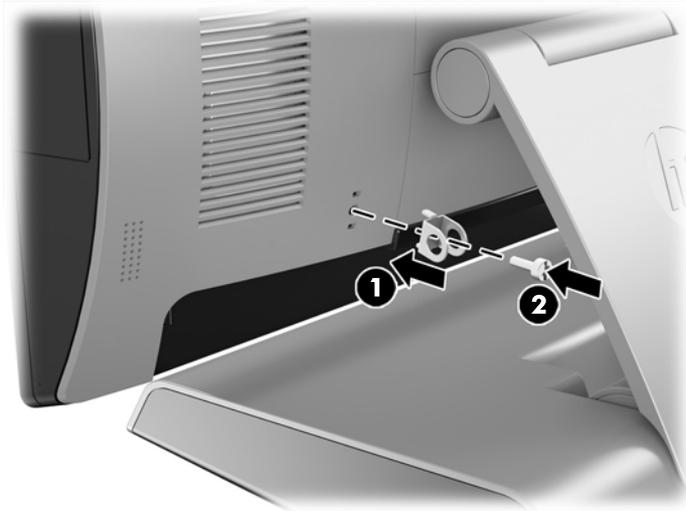
2. Povežite kabel koji je priključen za vanjski objekt za lokot i provucite lokot kroz sigurnosnu omču.
