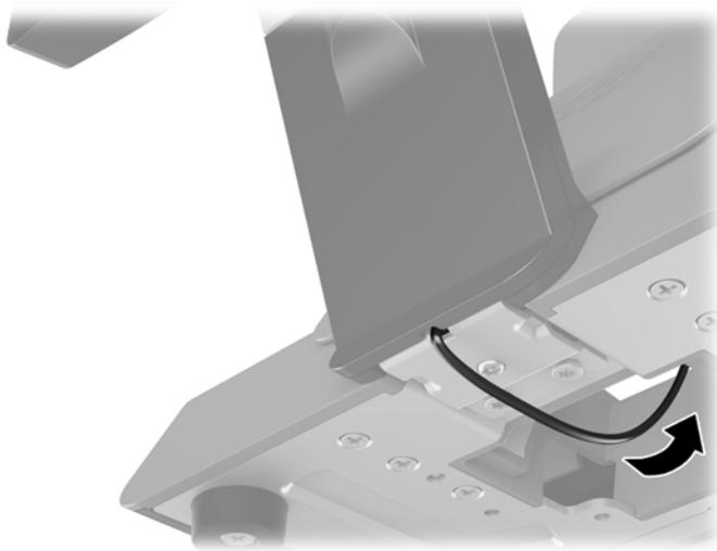
7. Spojite kabel napajanja i pritisnite gumb za uključivanje.
