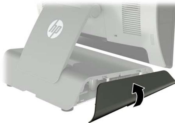
6. Postavite RP9 licem prema dolje na površinu pokrivenu čistom i suhom krpom. Podignite jezičac i otpustite vijak na donjoj ploči postolja (1), zatim podignite dno ploče (2) te povucite ploču s postolja (3).
