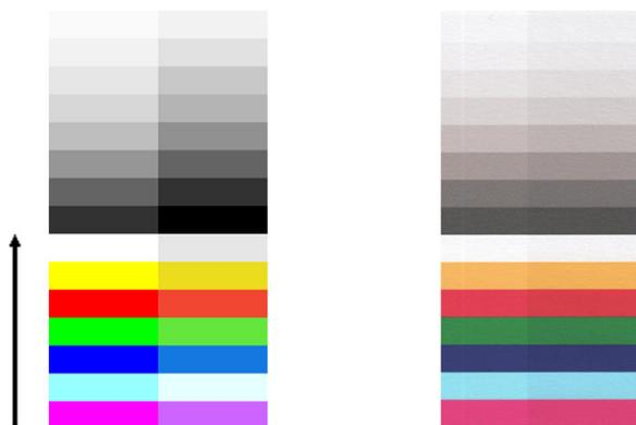
A volte, è possibile che la mancata corrispondenza dei colori tra moduli adiacenti sia enorme, evidenziando un grave malfunzionamento dello scanner, come riportato nel seguente esempio.
