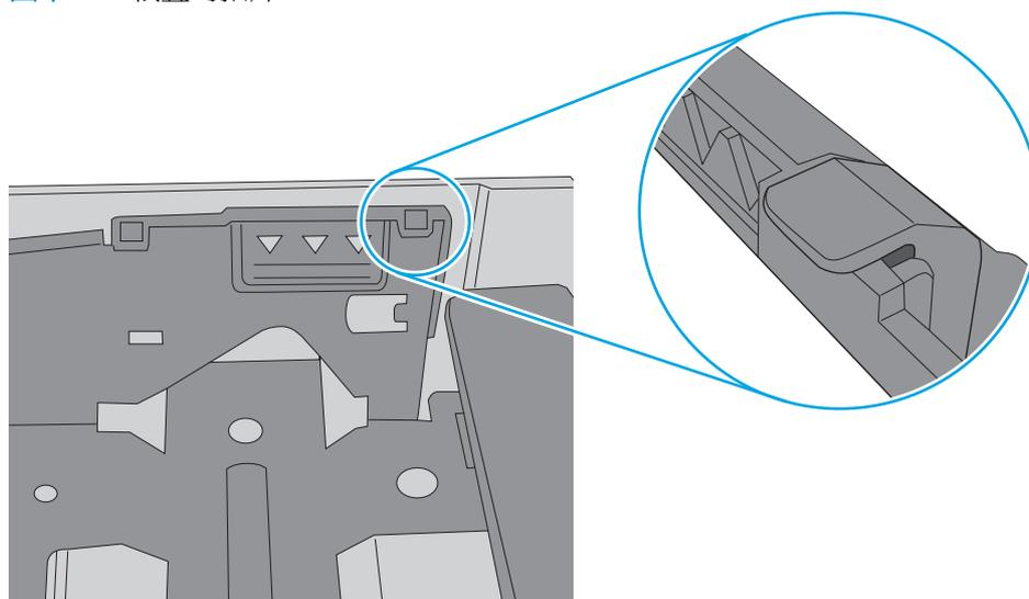
6. 確定已針對紙張尺寸正確調整紙匣的紙張導板。將導板調整至紙匣內的適當缺口。紙匣導板上的箭頭應與紙匣上的標記對齊。
