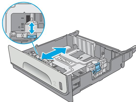
4. 將紙張裝入紙匣。檢查紙張，確認導板輕輕碰觸紙疊，但不要壓彎紙張。如需有關如何調整紙張方向的資訊，請參閱[位於第 23 頁的 2 號紙匣紙張方向](#)。
