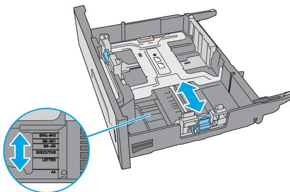
3. 擠壓調整鎖，並將導板滑動到正在使用的紙張尺寸，以調整紙張長度導板。
