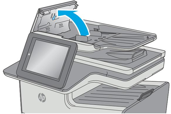
3. 使用壓縮氣體或以溫水浸濕的乾淨無絨布料，清除每個送紙滾筒和分隔墊中任何可見的絨絮或灰塵。
