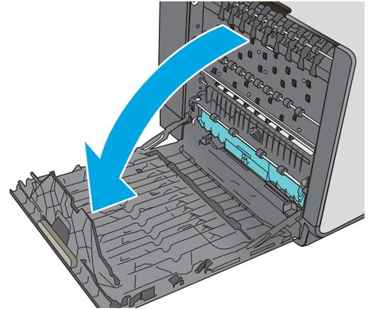
2. 輕輕地將任何卡紙從滾筒和送紙區中拉出。如果紙張已撕破，請確定取出所有剩餘碎片。
