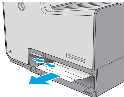
4. 取出所有卡紙和碎紙。確認紙匣未裝入太多紙張，紙張導板也已正確調整。
