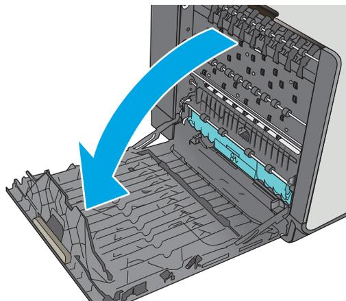
6. 輕輕地將任何卡紙從滾筒和送紙區中拉出。如果紙張已撕破，請確定取出所有剩餘碎片。
