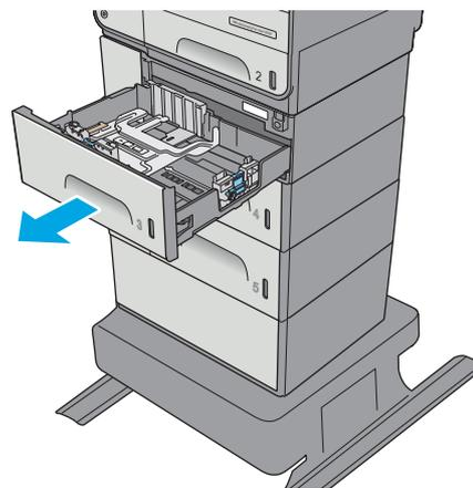
2. 裝入紙張前，請擠壓調整鎖，並將導板滑動到正在使用的紙張尺寸，以調整紙張寬度導板。紙匣導板的邊緣應與紙匣上的標記對齊。
