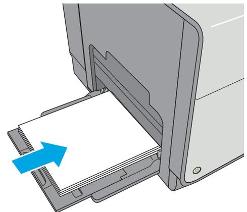
4. 請確定列印紙材符合紙張導板上的放置指示線。
