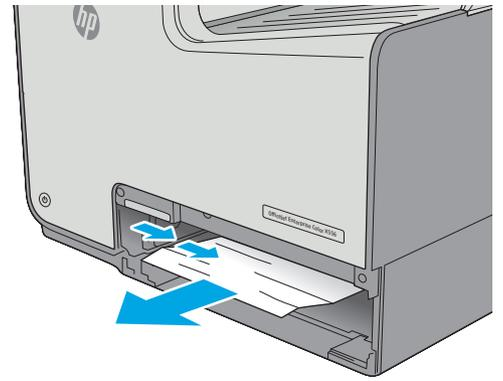
3. 取出所有卡紙和碎紙。確認紙匣未裝入太多紙張，紙張導板也已正確調整。
