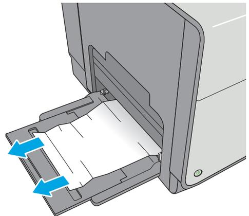
2. 稍微拉抬紙匣後，將 2 號紙匣從印表機中完全拉出
