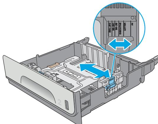
3. 擠壓調整鎖，並將導板滑動到正在使用的紙張尺寸，以調整紙張長度導板。
