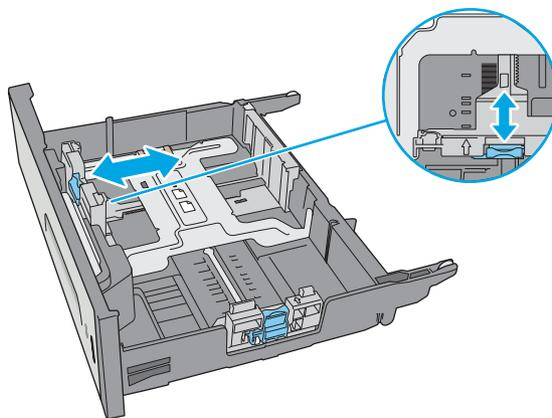
4. 將紙張裝入紙匣。檢查紙張，確認導板輕輕碰觸紙疊，但不要壓彎紙張。如需有關如何調整紙張方向的資訊，請參閱[位於第 27 頁的 3 號紙匣紙張方向](#)。
