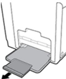
3. Legen Sie Umschläge in Fach 1 mit der Vorderseite nach unten und der oberen Kante des Umschlags in Richtung Vorderseite des Druckers ein.
