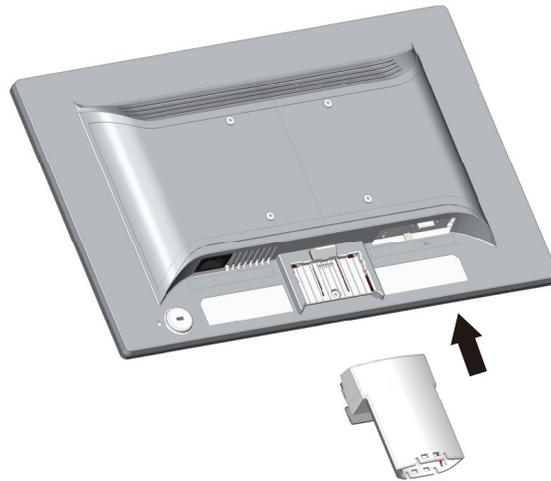
3. Pressione a base na coluna até que se encaixe na posição.
