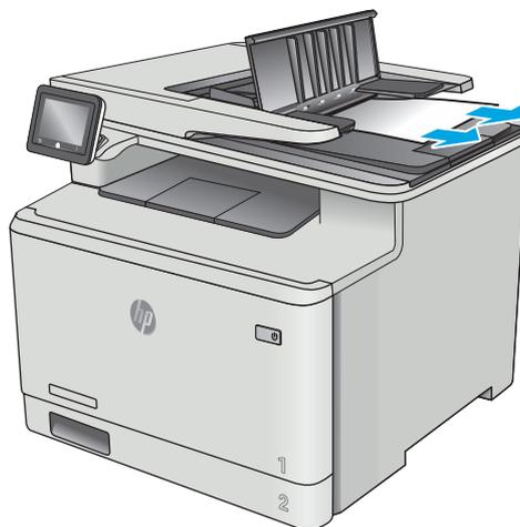
5. Ouvrez le couvercle du scanner. Si le papier est bloqué derrière le renfort en plastique blanc, retirez-le doucement.
